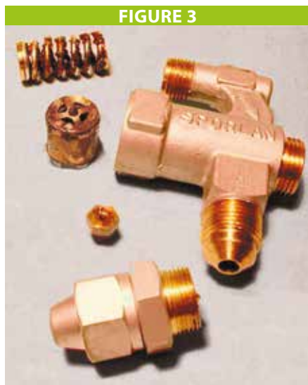
Détendeur thermostatique obstrué
