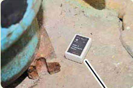
Ce capteur IdO détecte l'eau sur le plancher. Il envoie un signal (Z Wave dans ce cas-ci) au dispositif installé pour fermer le robinet lorsqu'une fuite est détectée. Une alarme peut également retentir et/ou un courriel être envoyé à une personne attitrée.
